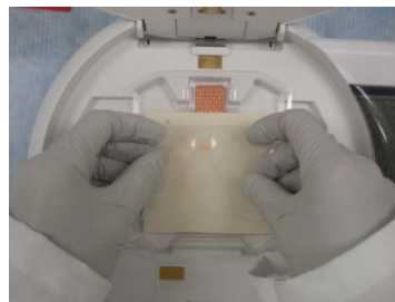
Transferring one mini gel
